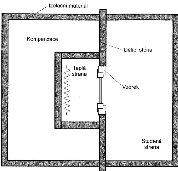
**Key:** Kompenzace: Compensation; Dělící stěna: Surround Panel; izolační materiál: Insulating material; Vzorek: Specimen; Teplá strana: Warm side; Studená strana: Cold side
